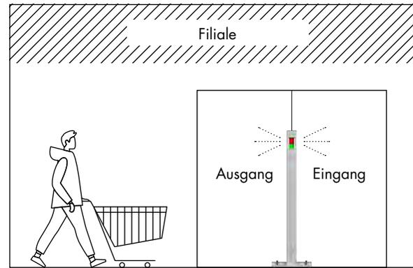
Aufstellung in der Mitte des Laufweges (Ampel mit 2 Sensoren für kombinierte Ein- und Ausgänge - mittige Positionierung)
