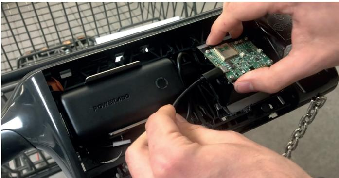
Abbildung - Einbau der Empfängerelektronik in den Griff
