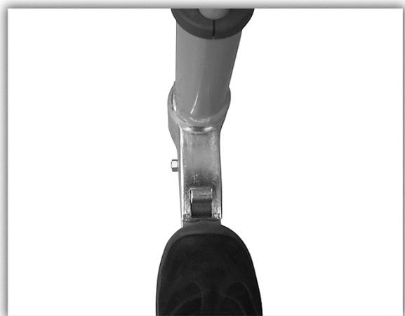
Pour débloquer, déplacer le levier supérieur dans le sens de la marche. Pour le verrouillage, déplacez la pédale vers le bas.
